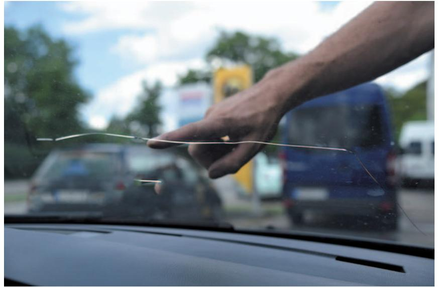
Foto: Axa Zu groß und im Sichtbereich – diese Scheibe muss erneuert werden.
